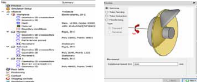
旋压分析设置流程及旋压类型选择
