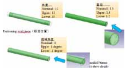
设计变量：毛坯长、直径、摆放角度
