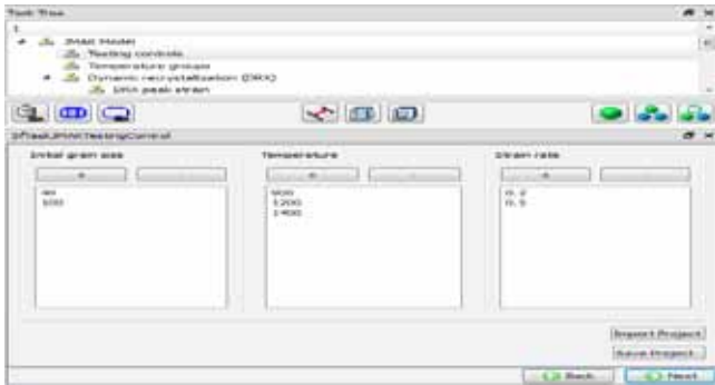
输入不同初始晶粒毛坯压缩实验的温度 - 应变率范围
