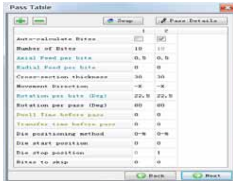
锻打工艺流程表（咬合、加热、锻打、旋转参数）
