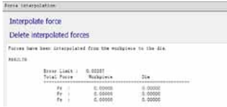
自动将成形模具受力加载到模具上进行计算
